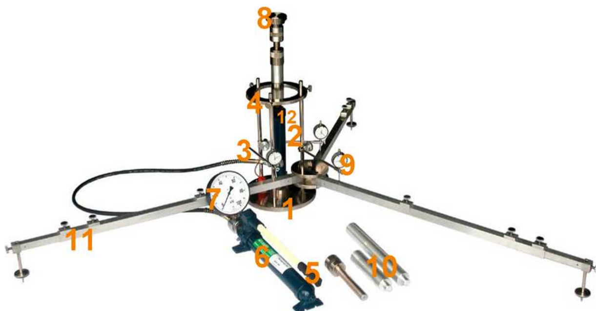
Rys. 1.1. Aparatura VSS z trzypunktowym pomiarem przemieszczenia płyty
