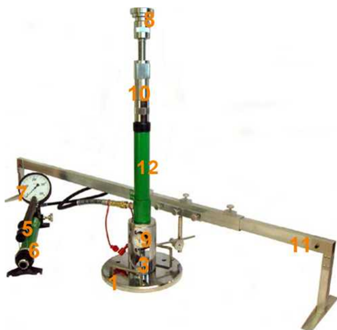
Rys. 1.2 Aparatura VSS z jednopunktowym pomiarem przemieszczenia płyty
